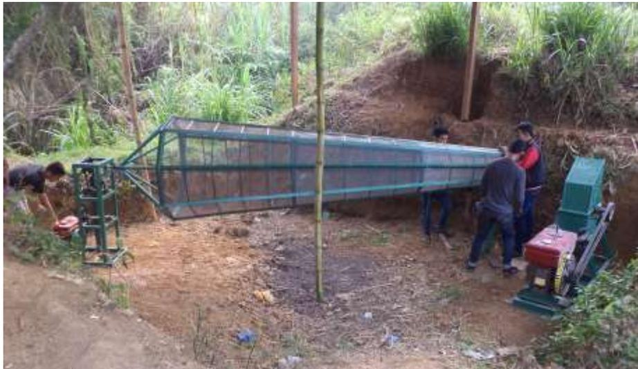
Gambar 4. Mesin Sortasi Dolomite di Lokasi
